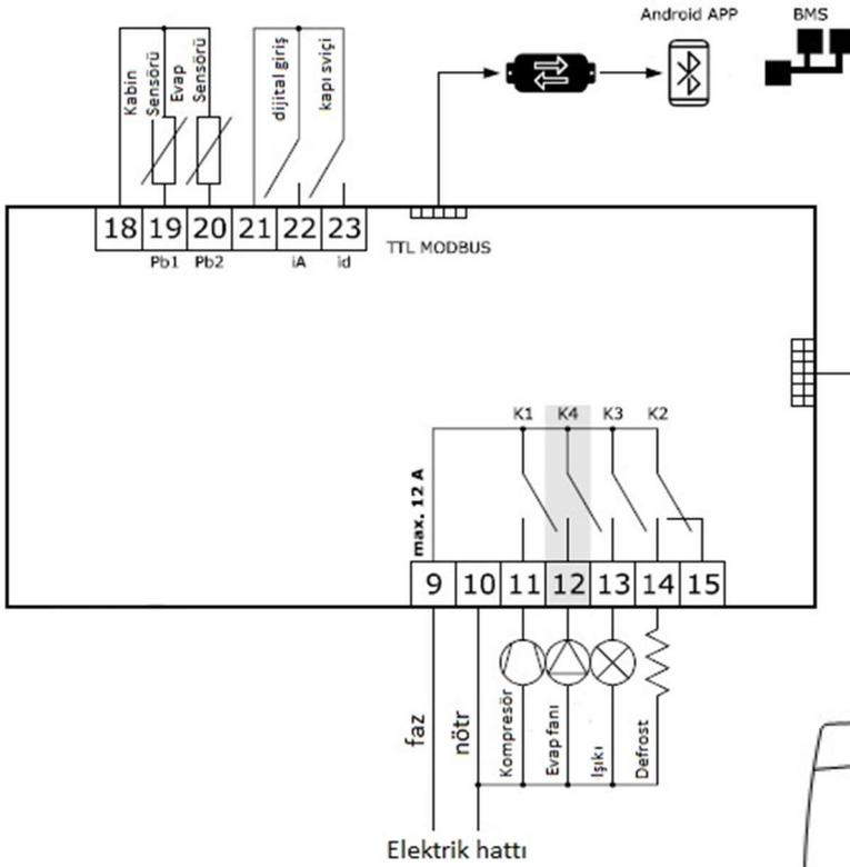
Not: Dijital termostatın kontakları "DIRECT LOAD" tipi kendinden elektrikli bağlantılıdır. 9 nolu uca verilen faz, cihazın kontak vermesini müteakip doğrudan rölelere aktarılır. **Başka bir deyişle dijital termostata bir kez akım verildiğinde, köprüleme yapılmasına gerek yoktur.** 12 den Evaporatör fanına, 11 den kompresöre, 14 den defrosta ve 13 ten de kabin lambasına (veya 4. Röle olarak atama yaptığınız unsura) faz verilmiş olur .
